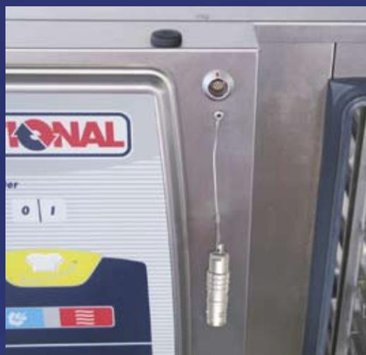
Presca di collegamento per sensore della temperatura del nucleo Sous-Vide e Standard
