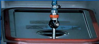
Una valvola di blocco a chiusura automatica facilita la sostituzione del contenitore di raccolta dei grassi durante il funzionamento
