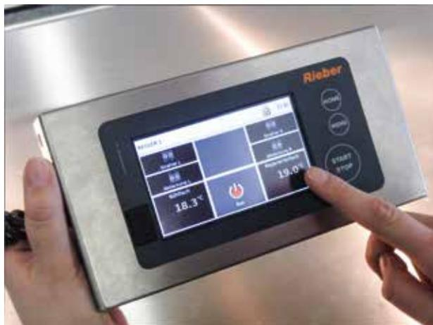
Die neue Steuerung ist integriert in ein geschlossenes Edelstahlgehäuse. Sie ist herausnehmbar und so einfach im Handling. An der Licht-/Wärmebrücke gibt es seitlich eine Aufnahme zur sicheren Verstauerung der Steuerung. In die Aufnahme lässt sich die Steuerung in 2 Positionen einsetzen: Fest installiert und platzsparend zum Transport und zur Ausgabe, oder bedienseitig sicht- und bedienbar.
