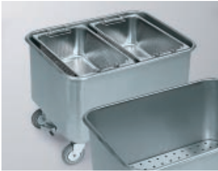
Kartoffel- und Gemüsewaschwagen CNS-Becken, tiefgezogen mit Wulstrand, Hebelablaufventil mit Sieb 2". Passend für: 4 x GN-Behälter 11194 K. Rostfreie Rollenausstattung gemäß DIN 18867, Teil 8.
