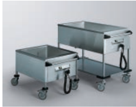
Bestecktauchwagen aus CNS Mit eingeschweißtem Becken, isoliert, mit Siebventil und Kugelablaßhahn 1", beheizbar. Verkleidung mit Schalterblende, Spiralkabel 2,5 m, Schukostecker und Blindsteckdose. Ein/Aus-Schalter. Thermostat-Regler +30 bis +110 °C. Schiebegriff. Rostfreie Rollenausstattung gemäß DIN 18867, Teil 8.
