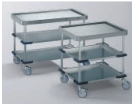
Unterbau Quadratrohr. 2 tiefgezogene Borde mit Stopprand, eingeschweißt mit je 4 Stoßecken.
