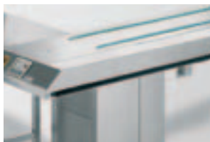
Rundriemenband für Speiserverteilung Abmessungen B x H 500 x 900 mm
